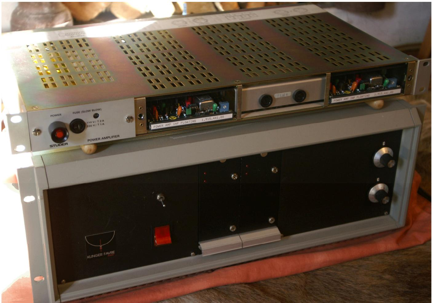
Photo 2 – Amplificateurs de puissance modulaires discrets Klinger Favre (bas) et Studer (haut)
